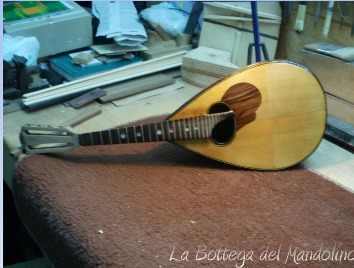
Si possono notare le operazioni di sostituzione del battipenna in legno massello di palissandro e l'applicazione della finitura protettiva a tampone.
